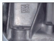
对于易产生光泽、照明不均的金属面也可进行稳定检查
